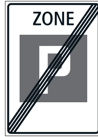
2.59.2c Signal de fin de zone parquage autorisé
