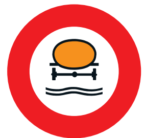
2.11 Circulation interdite aux véhicules dont le chargement peut altérer les eaux
