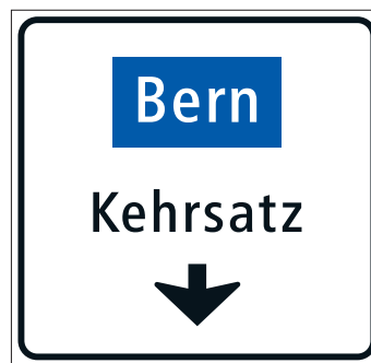
4.42 Panneau de présélection au-dessus d'une voie de circulation sur route secondaire
