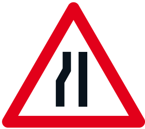
1.09 Chaussée rétrécie à gauche
