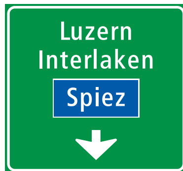
4.69 Panneau de présélection au-dessus d'une voie de circulation sur autoroute et semi-autoroute
